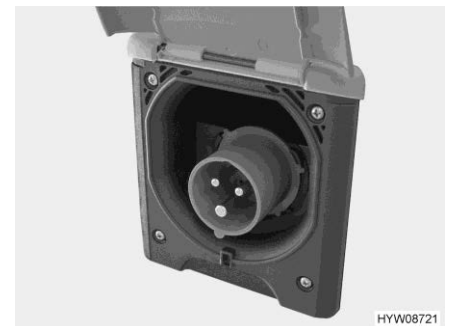
Afb. 101 230-V-aansluiting op het voertuig (CEE-contactdoos)
