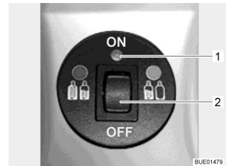
Afb. 93 Bedieningspaneel met afstandsindicatie
