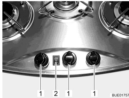
Afb. 128 Bedieningselementen voor gaskooktoestel
