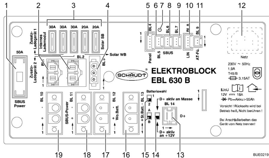
Fig. 187 Transformer/rectifier (EBL 630)
