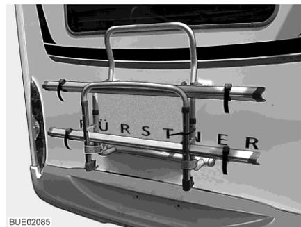
Bild 1 Fahrradträger, nicht absenkbar
