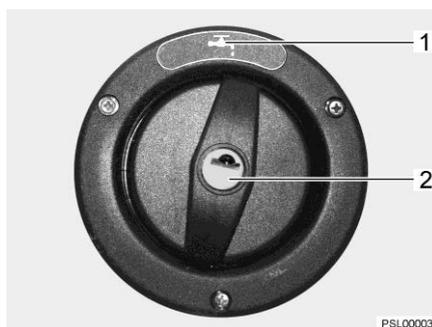
Bild 267 Trinkwasser-Einfüllstutzen in Seitenwand des Fahrzeugs
