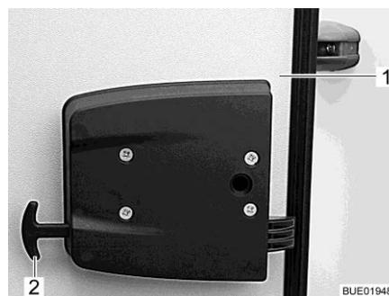
Bild 58 Notentriegelung Garagenklappe
