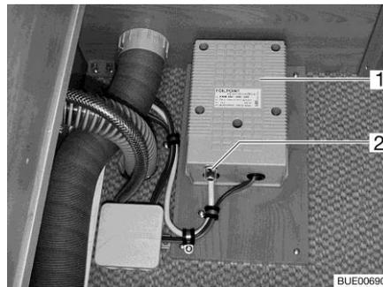
Bild 233 Trafo für elektrische Fußbodenerwärmung
