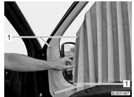
Bild 104 Befestigung Faltschirm
