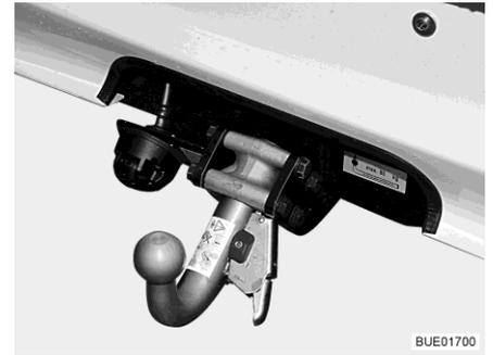
Bild 7 Anhängerkupplung, abnehmbar
