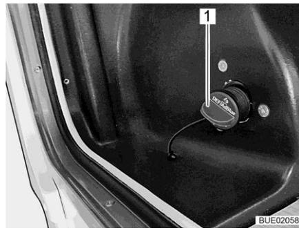
Bild 43 Einfüllstutzen für AdBlue®
