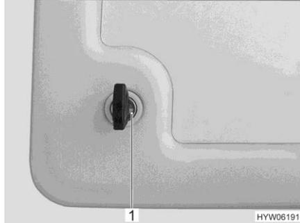
Bild 59 Druckschloss Serviceklappe
