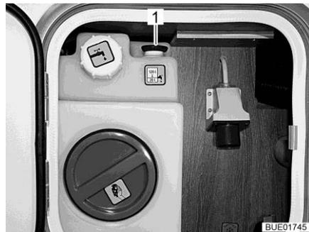
Bild 273 Wassertank (Service-Unit)
