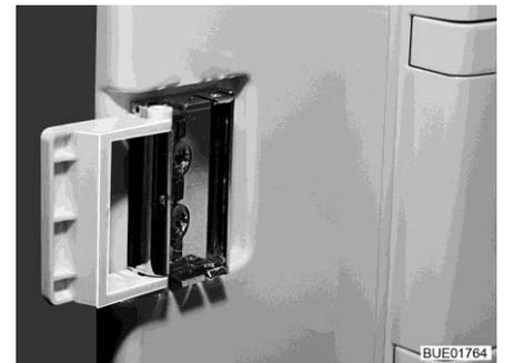
Bild 264 Verschlusseinrichtung in Lüftungsstellung
