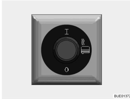
Bild 283 Schalter für Abwasserheizung
