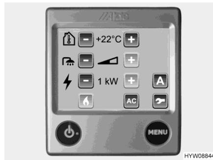
Bild 224 Einstellmenü (Bedieneinheit)
