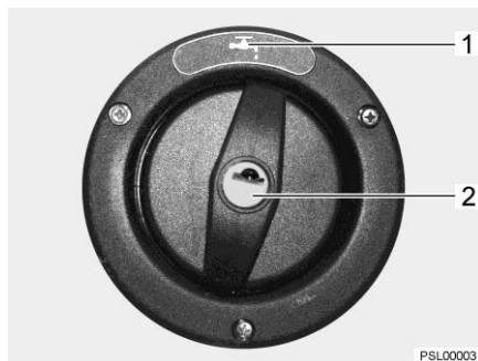
Afb. 249 Drinkwatervulopening in zijwand van het voertuig
