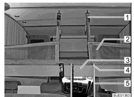
Afb. 141 Hefbed met gespannen veiligheidsnet
