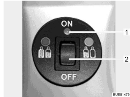
Afb. 175 Bedieningspaneel met afstandsindicatie
