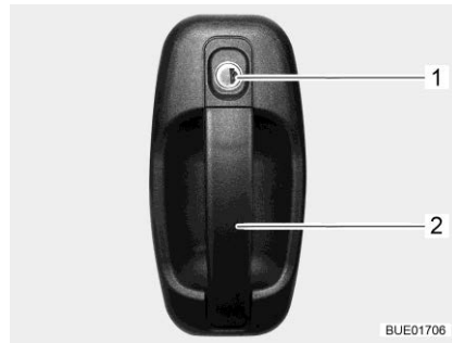
Kuva 68 Oven lukko (sisäänkäyntiovi ulkoa)
