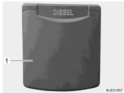
Kuva 54 Polttoaineen täyttöaukon ulkoluukku
