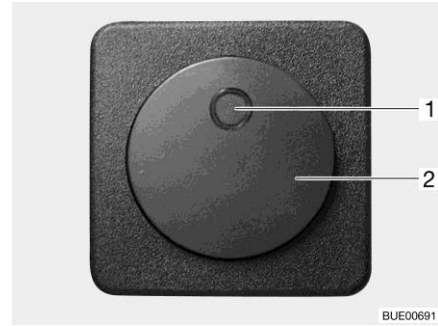
Kuva 224 Sähköisen lattialämmityksen kytkin
