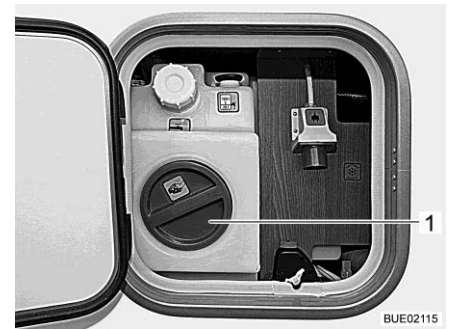
Kuva 281 Vesisäiliön puhdistusaukko (huoltoyksikkö)
