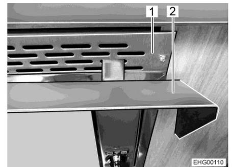
Fig. 233 Chapa protectora de calor (enganchada)
