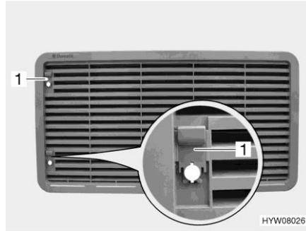
Fig. 239 Rejilla de ventilación del frigorífico (con corredera)
