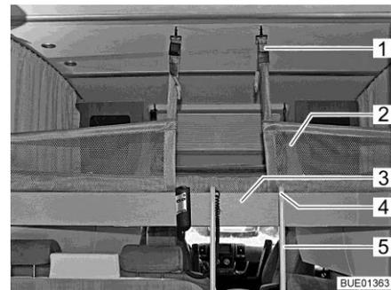
Fig. 141 Cama elevada con red de seguridad tendida
