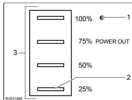
Fig. 185 Indicador de estado del regulador de carga solar
