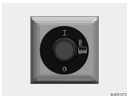
Fig. 265 Interruptor para calefacción de aguas residuales
