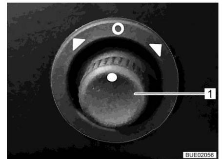
Fig. 40 Interruptor giratorio de ajuste de los retrovisores exteriores
