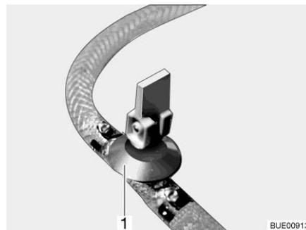
Fig. 251 Llave de desagüe (con balancín)
