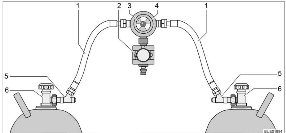
Fig. 16 Regulador de gas con CPU y dispositivo de seguridad en caso de rotura de manguera
