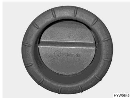
Fig. 207 Boquilla de salida de aire (calefacción de aire caliente)
