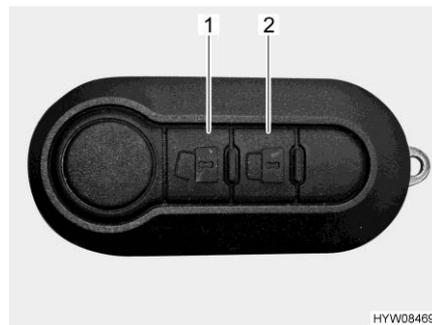
Fig. 63 Mando a distancia del cierre centralizado (2 teclas)
