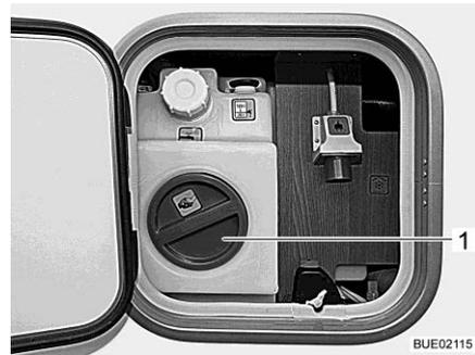
Fig. 281 Orificio de limpieza del depósito de agua (unidad de servicio)
