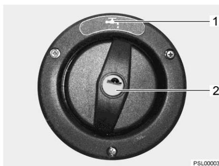
Fig. 249 Tubo de llenado de agua potable en la pared lateral del vehículo
