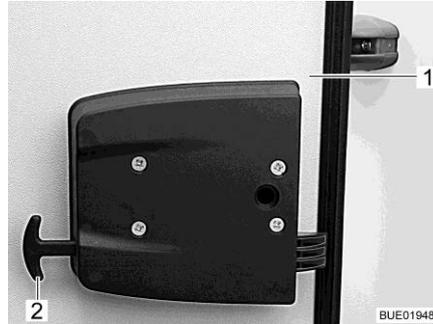
Fig. 73 Desbloqueo de emergencia de la trampilla del garaje
