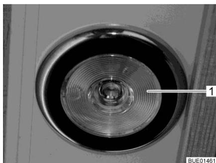
Fig. 98 Lámpara empotrada, interruptor de luz dentro de la lámpara
