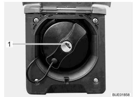
Fig. 55 Tapa de cierre para el tubo de llenado de combustible
