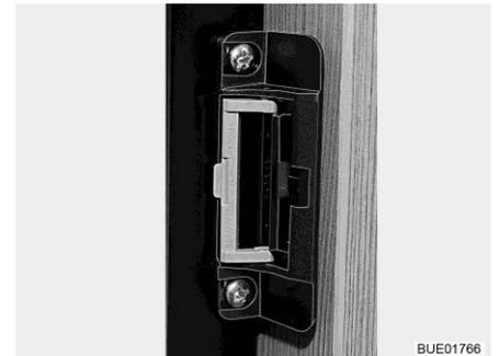
Fig. 245 Dispositivo de cierre en posición de ventilación
