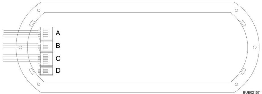
Fig. 204 Esquema de conexión, panel (LT 633)
