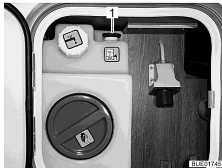
Fig. 255 Depósito de agua (unidad de servicio)
