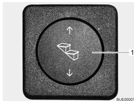
Fig. 10 Pulsador basculante, escalón de entrada
