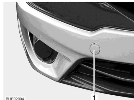
Fig. 57 Tapa para el alojamiento de la argolla de remolque (ejemplo)
