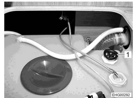
Fig. 256 Depósito de agua (alternativa)
