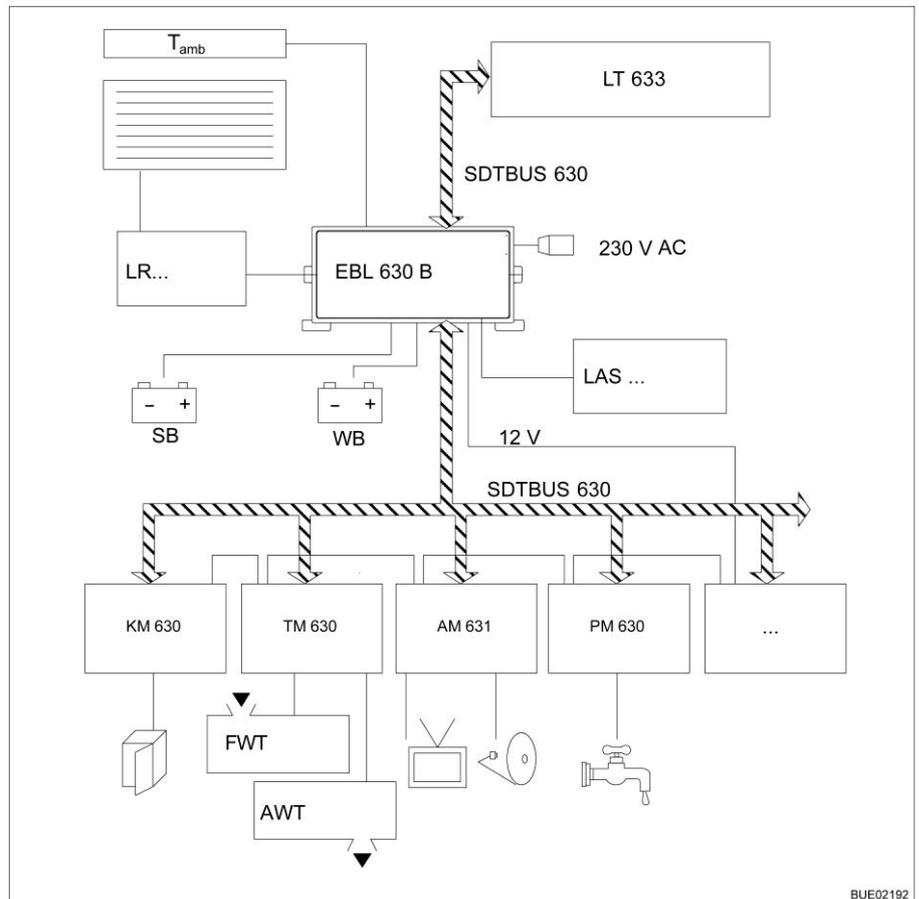
Fig. 202 Diagrama de bloques del suministro de energía de EBL 630
