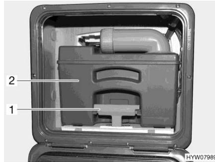
Fig. 269 Depósito de aguas fecales (ejemplo)
