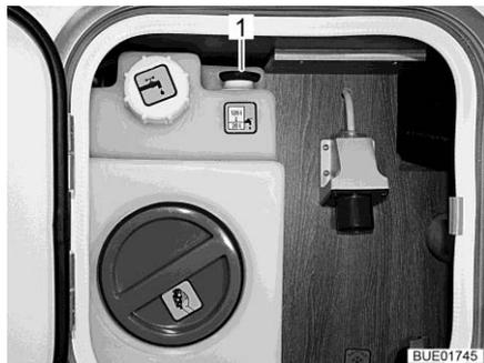
Fig. 257 Depósito de agua (unidad de servicio)
