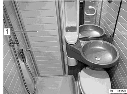
Fig. 13 Panel de separación de la ducha
