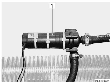
Fig. 218 Bomba de circulación adicional
