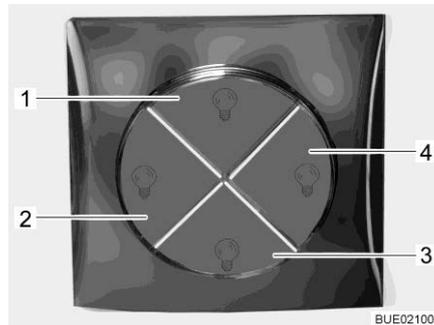
Fig. 101 Interruptores para mando de luces
