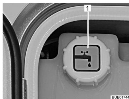
Fig. 250 Tubo de llenado de agua potable en la unidad de servicio (alternativa)
