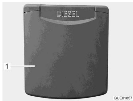
Fig. 54 Trampilla exterior, tubo de llenado de combustible
