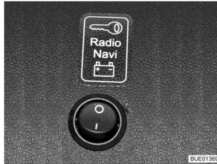
Fig. 180 Conmutador selector de alimentación de corriente
