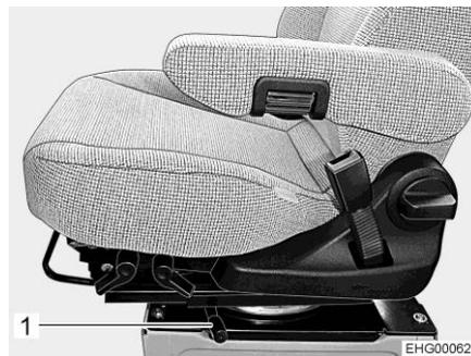
Fig. 22 Palanca de desbloqueo para girar
