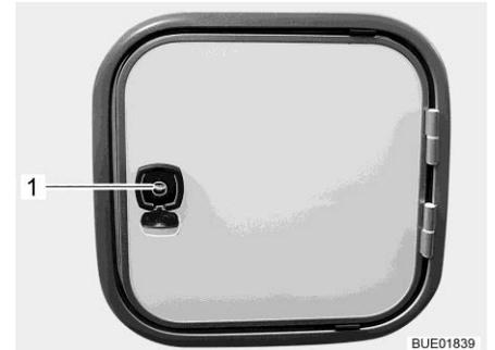
Fig. 277 Trampilla para el depósito de aguas fecales (alternativa)
