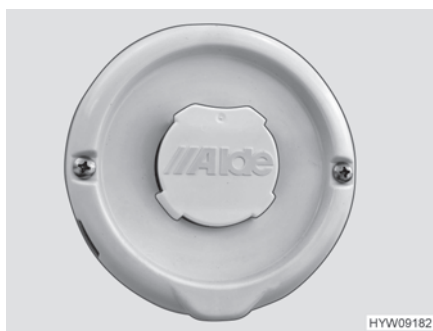
Fig. 144 Cheminée murale (chauffage à eau chaude)
