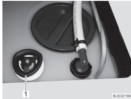
Fig. 167 Réservoir d'eau avec poignée tournante
