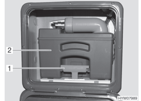
Fig. 181 Réservoir pour matières fécales
