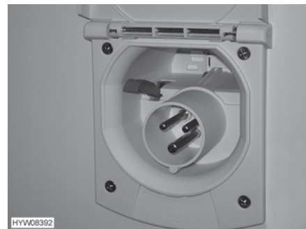
Fig. 122 Raccordement 230 V sur le véhicule
