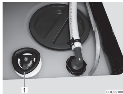
Fig. 182 Réservoir d'eau avec poignée tournante
