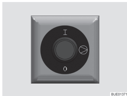
Fig. 142 Commutateur de commande du circulateur supplémentaire
