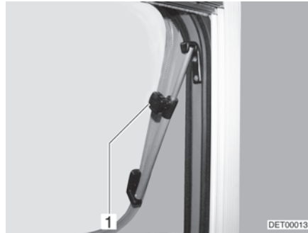
Fig. 69 Fenêtre projetante avec bras pivotant
