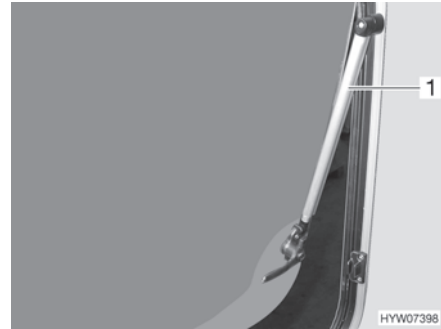
Fig. 70 Fenêtre projetante avec bras automatique
