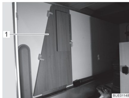
Fig. 11 Rallonge latérale de lit dans le garage arrière
