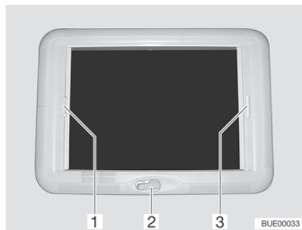
Kuva 83 Kammella nostettava kattoluukku
