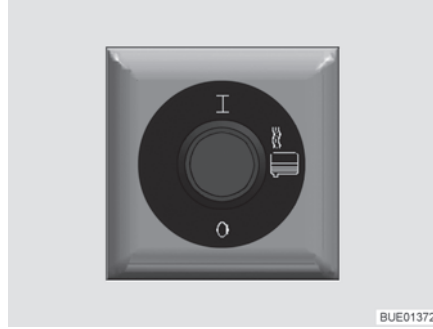
Kuva 172 Kytkin jäteveden lämmitykselle
