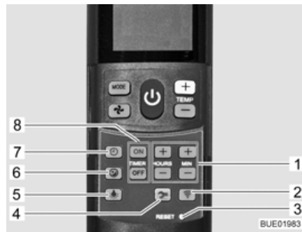
Kuva 170 Kaukosäätimen asetuspainikkeiden lähikuva (ilmastointilaitte)
