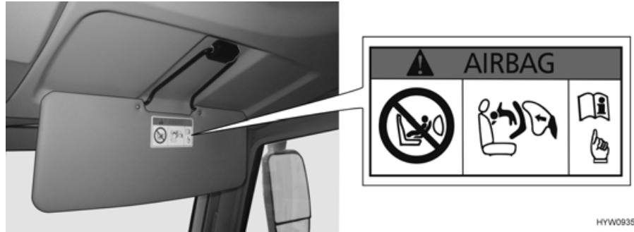
Kuva 25 Lasten turvalaitteisiin liittyvä varoitus (apuohjaajan häikäisysuoja)
