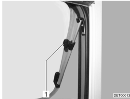
Kuva 95 Avattavat ikkunat, joissa on kääntöpideke
