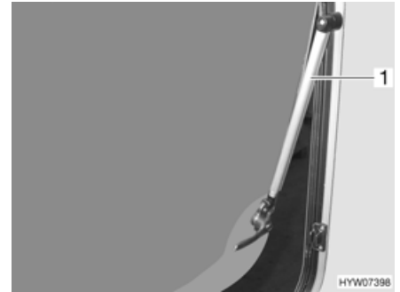
Kuva 96 Avattavat ikkunat, joissa on automaattipidekkeet
