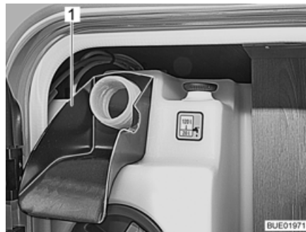
Fig. 191 Aide au remplissage
