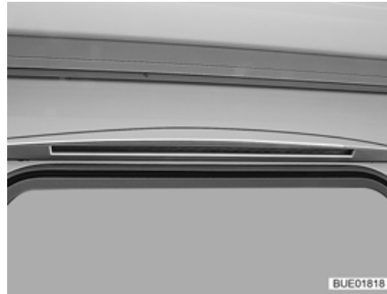
Fig. 78 Eclairage de l'auvent
