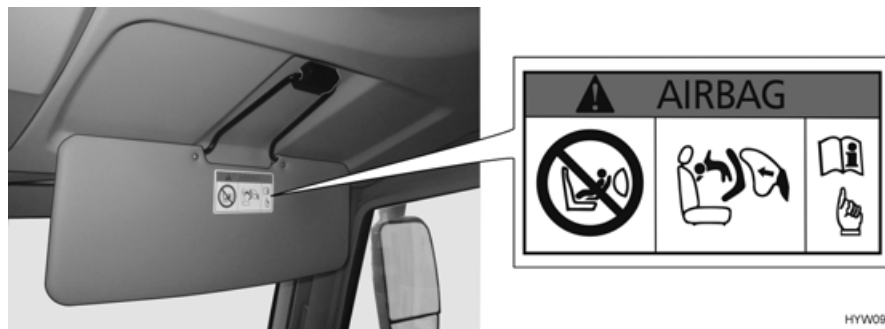
Fig. 25 Indication de sécurité du système de retenue pour enfants (pare-soleil du passager)
