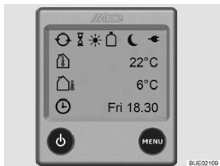
Fig. 156 Écran de démarrage (unité de commande)
