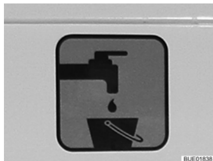
Fig. 195 Symbole du tuyau de purge
