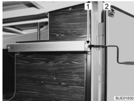
Fig. 124 Manivelle dans le garage arrière
