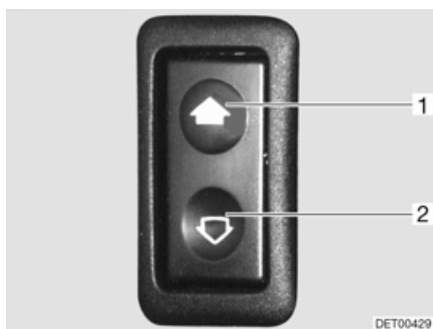
Fig. 32 Interrupteur pour lève-vitres électriques
