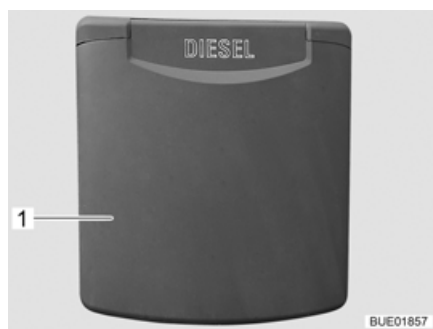
Fig. 44 Portillon extérieur bec de remplissage du carburant
