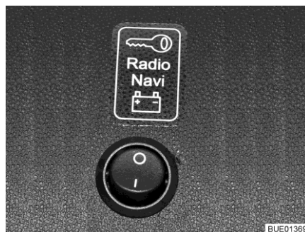
Bild 181 Wahlschalter für Betriebsverhalten
