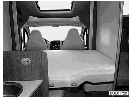
Bild 139 Hubbett, ganz abgesenkt (modellabhängig)
