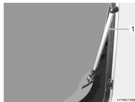
Bild 92 Ausstellfenster mit Automatik-Aussteller
