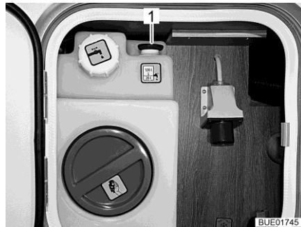
Bild 266 Wassertank (zentrale Versorgungseinheit)
