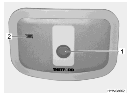
Bild 284 Spülknopf/Kontroll-Leuchte Thetford-Toilette (Alternative)
