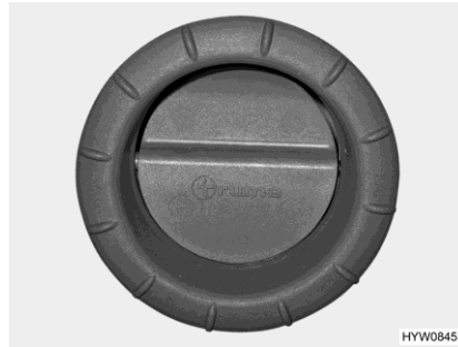
Fig. 210 Bocchetta di uscita dell'aria (riscaldamento ad aria calda)
