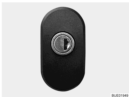
Fig. 58 Serratura dello sportello, bloccata
