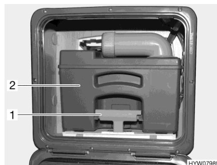
Fig. 278 Serbatoio fecale (esempio)
