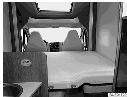
Fig. 139 Letto basculante, completamente abbassato (a seconda del modello)
