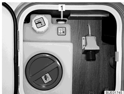
Fig. 266 Serbatoio dell'acqua (unità di alimentazione centrale)
