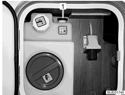
Fig. 265 Serbatoio dell'acqua (unità di alimentazione centrale)
