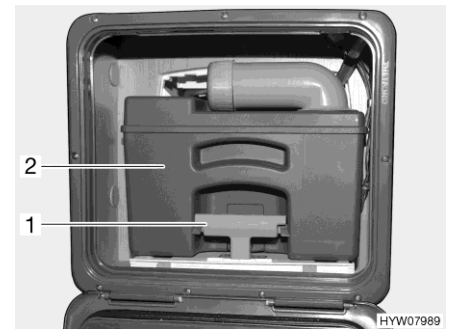
Fig. 290 Serbatoio fecale (esempio)
