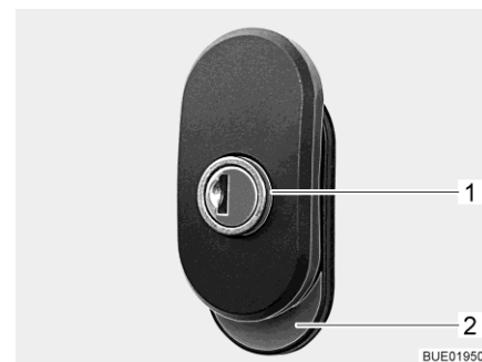
Fig. 59 Serratura dello sportello, bloccata
