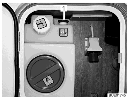
Fig. 265 Réservoir d'eau (unité d'alimentation centrale)
