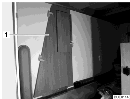
Fig. 14 Rallonge latérale de lit dans le garage arrière
