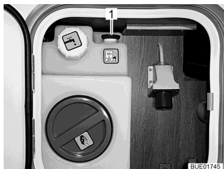
Fig. 266 Réservoir d'eau (unité d'alimentation centrale)
