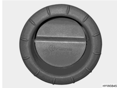
Fig. 210 Buse de sortie d'air (chauffage à air chaud)
