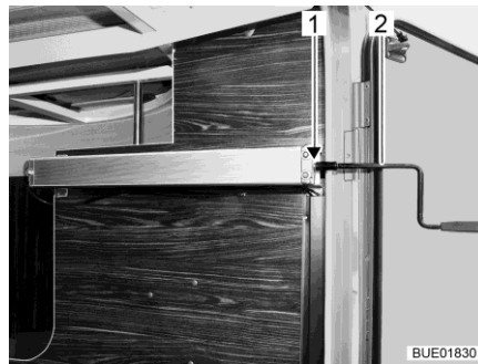
Fig. 131 Manivelle dans le garage arrière
