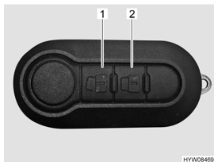
Afb. 58 Afstandsbediening centrale vergrendeling (2 toetsen)
