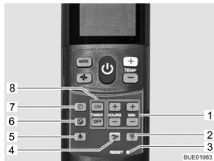
Afb. 170 Afstandsbediening met insteltoetsen (klimaatregeling)
