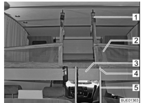
Afb. 122 Hefbed met gespannen veiligheidsnet
