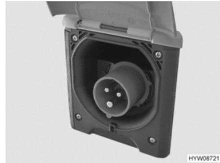
Afb. 142 230-V-aansluiting op het voertuig
