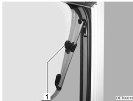
Afb. 95 Uitzetbaar raam met draaibare uitzetters
