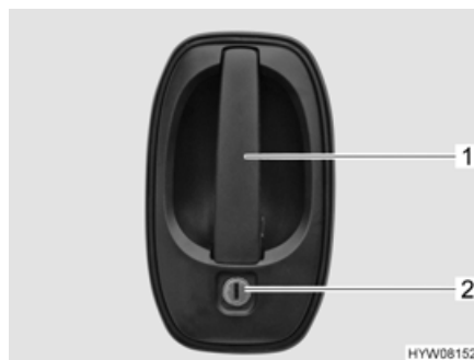
Afb. 61 Deurslot (bestuurdersdeur/ ingangsdeur, buiten)
