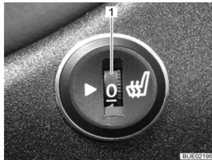
Fig. 29 Rueda de ajuste, calefacción de asiento
