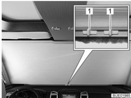
Fig. 19 Oscurecedor manual de la luna delantera
