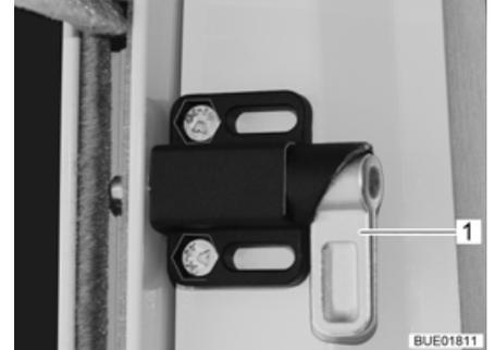
Fig. 21 Pestillo de seguridad
