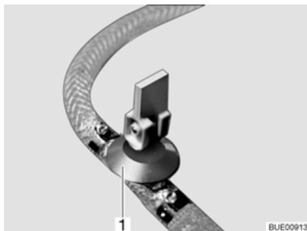
Fig. 194 Llave de desagüe (con balancín)
