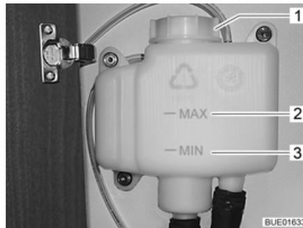
Fig. 212 Recipiente de compensación sin panel
