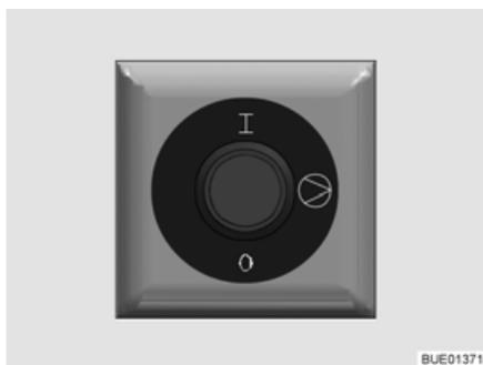
Fig. 162 Conmutador de mando de la bomba de circulación adicional
