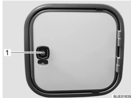
Fig. 208 Trampilla para el depósito de aguas fecales
