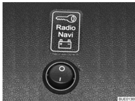
Fig. 137 Conmutador selector para el comportamiento de funcionamiento
