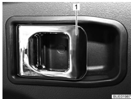
Fig. 62 Cerradura de la puerta del conductor, en el interior
