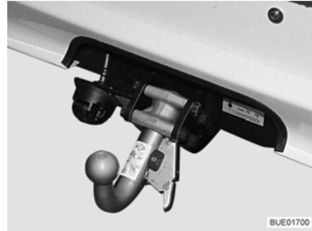
Fig. 8 Acoplamiento de remolque, desmontable
