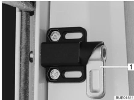
Fig. 103 Pestillo de seguridad, oscurecedor de la luna delantera
