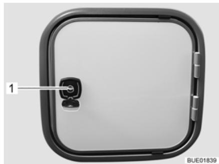
Fig. 200 Trampilla para el depósito de aguas fecales
