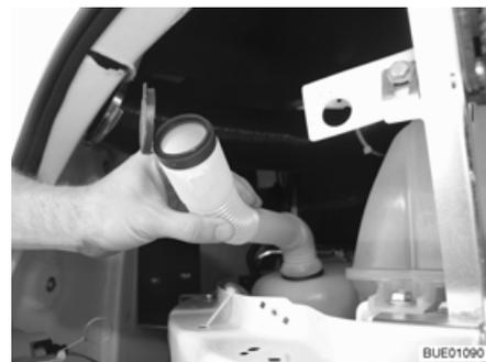
Fig. 43 Tubo de llenado en posición de llenado
