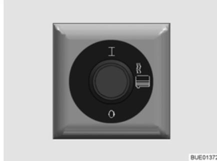
Fig. 198 Interruptor para calefacción de aguas residuales
