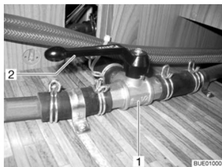
Fig. 159 Válvula de 3 vías
