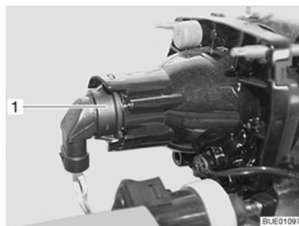
Fig. 216 Luz de cruce / luz larga / luz de estacionamiento
