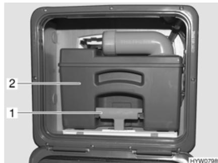
Fig. 209 Depósito de aguas fecales (ejemplo)
