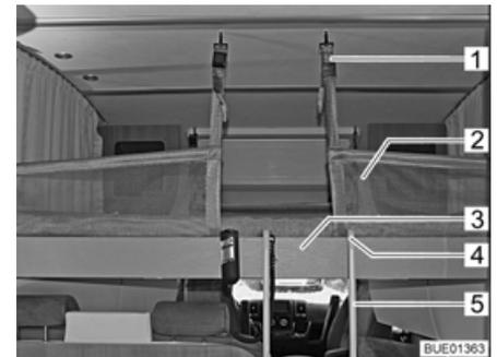
Fig. 122 Cama elevada con red de seguridad tendida
