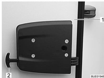
Fig. 67 Desbloqueo de emergencia de la trampa del garaje
