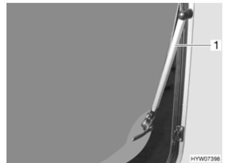
Fig. 96 Ventana abatible con soporte automático
