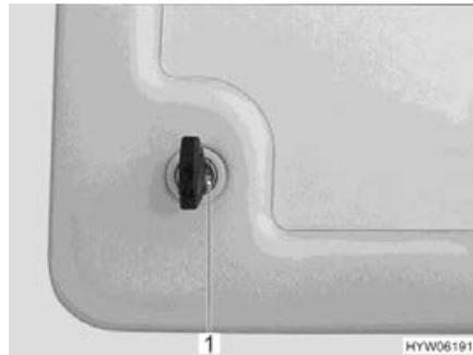
Bild 82 Druckschloss Serviceklappe
