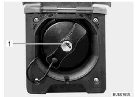
Bild 57 Verschlussdeckel für Kraftstoff-Einfüllstutzen
