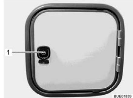
Bild 265 Klappe für Fäkalientank (Alternative)
