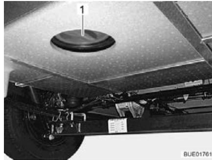
Bild 279 Reinigungsoffnung (Abwassertank)
