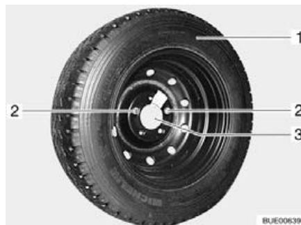
Bild 305 Ersatzrad-Halterung in der Heckgarage
