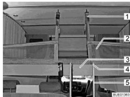
Bild 142 Hubbett mit aufgespanntem Sicherungsnetz
