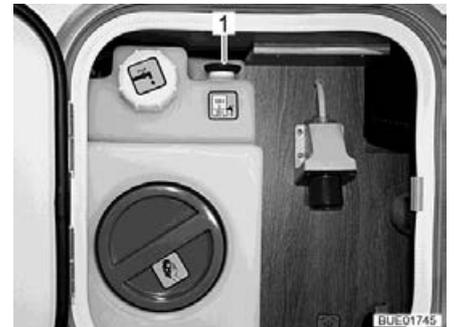
Bild 253 Wassertank mit Drehgriff in Service-Unit
