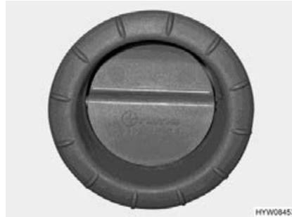
Bild 204 Luftaustrittsdüse (Warmluft-Heizung)
