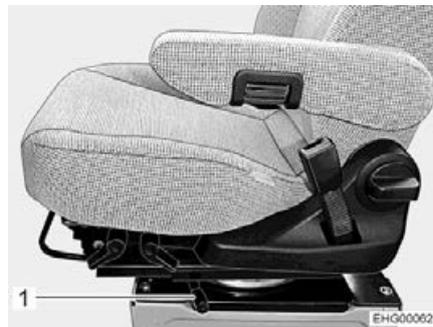
Bild 24 Entriegelungshebel zum Drehen
