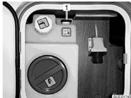
Bild 255 Wassertank mit Drehgriff in Service-Unit
