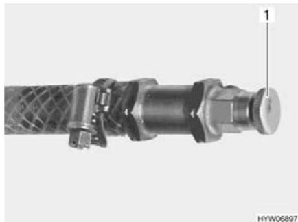
Bild 281 Entlüftungsventil Warmwasser-Heizung
