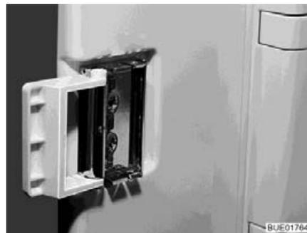
Bild 245 Verschlusseinrichtung in Lüftungsstellung
