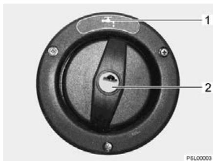
Bild 246 Trinkwasser-Einfüllstutzen (Lyseo I)
