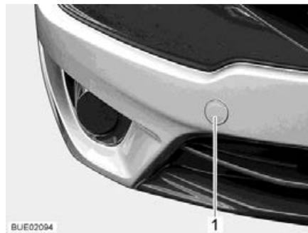
Bild 59 Abdeckung für die Aufnahme der Abschleppöse (Beispiel)
