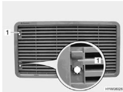
Bild 236 Kühlschrank-Lüftungsgitter (mit Schieber)
