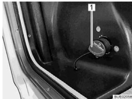
Bild 58 Einfüllstutzen für AdBlue®
