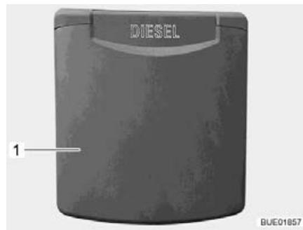
Bild 56 Außenklappe Kraftstoff-Einfüllstutzen
