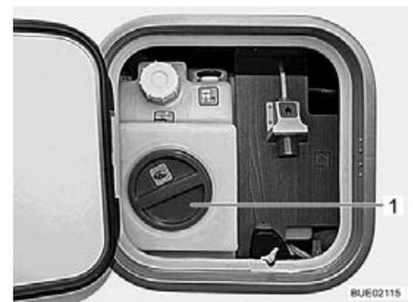
Bild 278 Reinigungsoffnung Wassertank (Service-Unit)
