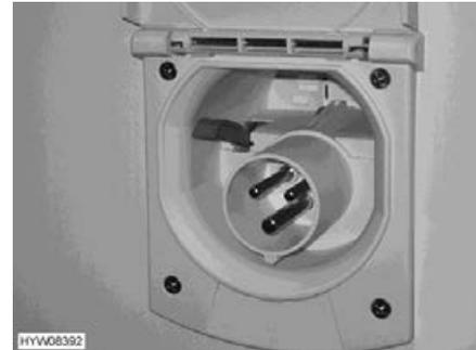
Bild 189 230-V-Anschluss am Fahrzeug
