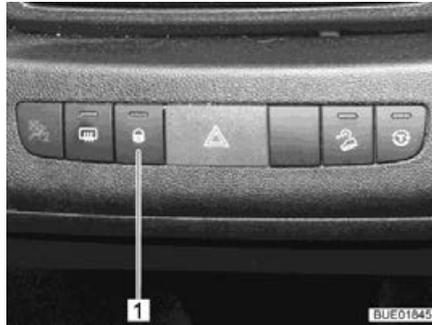
Bild 69 Schalter Zentralverriegelung
