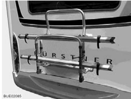
Bild 2 Fahrradträger, nicht absenkbar
