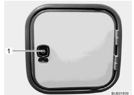
Bild 274 Klappe für Fäkalientank (Alternative)
