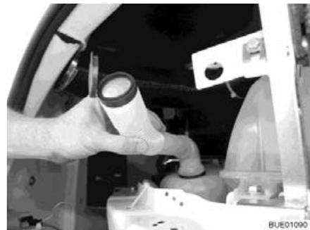
Bild 55 Einfüllstutzen in Füllposition
