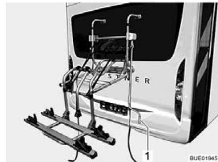
Bild 4 Fahrradträger, abgesenkt
