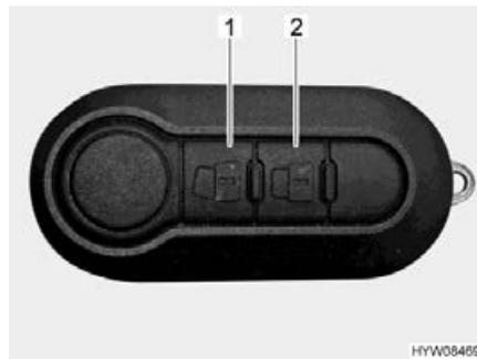
Bild 67 Fernbedienung Zentralverriegelung (2 Tasten)
