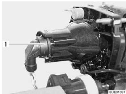
Bild 287 Abblendlicht/Fernlicht/Standlicht
