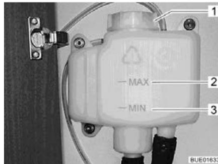
Bild 280 Ausgleichsbehälter ohne Blende
