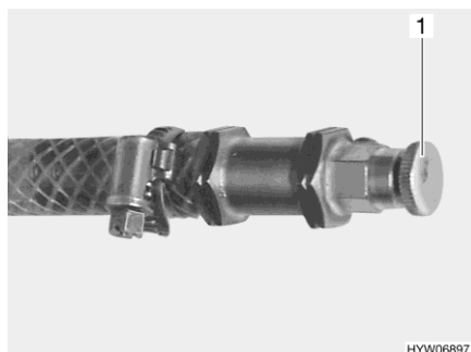
Billede 281 Udluftningsventil varmtvandsvarmeovn
