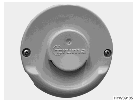
Billede 219 Vægskorsten (varmluft- varmeovn)
