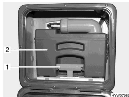
Billede 275 Toilettank (eksempel)
