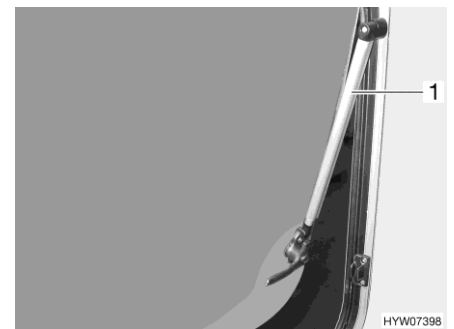
Billede 115 Ventilationsrude med automatiske udskydere
