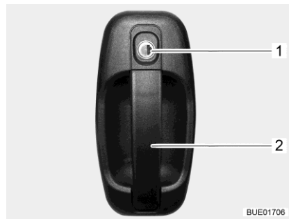
Billede 72 Dørlås (indgangsdør udvendigt)
