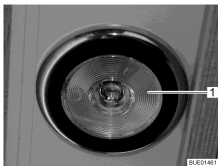
Billede 101 Indbygget lampe, lyskontakt i lampen
