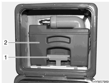
Billede 266 Toilettank (eksempel)
