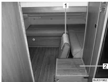
Billede 132 Opbevaringsrum og fjernet ryghynde
