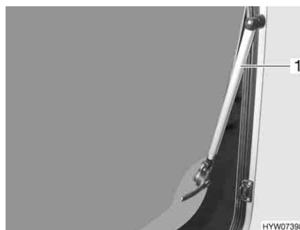
Billede 82 Ventilationsrude med automatiske udskydere
