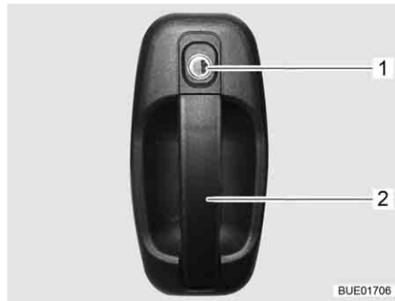
Billede 45 Indgangsdørens dørlås, udvendigt
