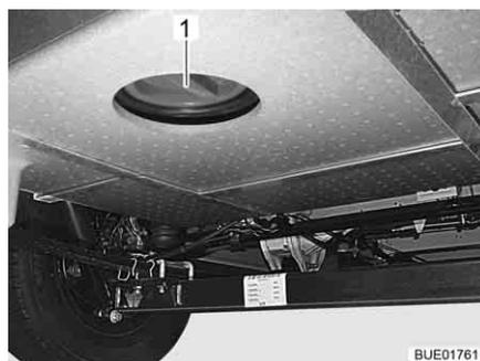
Bild 263 Reinigungsöffnung Abwassertank
