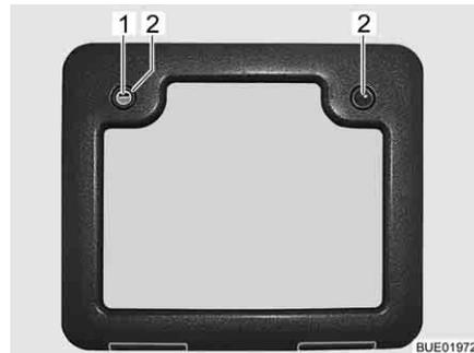
Bild 52 Druckschloss Serviceklappe (Alternative)
