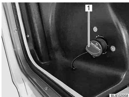
Bild 33 Einfüllstutzen für AdBlue®
