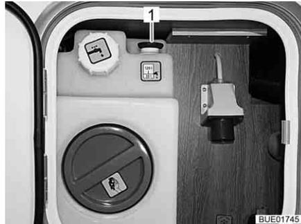
Bild 241 Wassertank (zentrale Versorgungseinheit)
