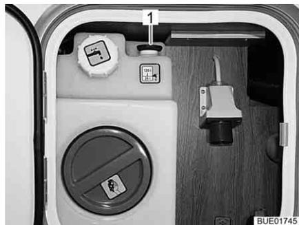
Bild 242 Wassertank (zentrale Versorgungseinheit)
