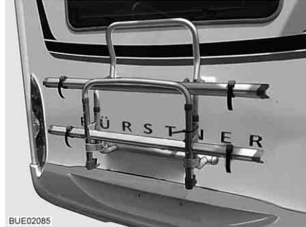
Bild 1 Fahrradträger, nicht absenkbar
