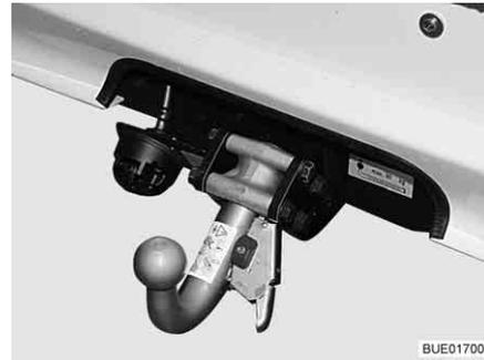
Bild 7 Anhängerkupplung, abnehmbar
