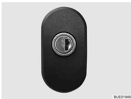
Bild 53 Klappenschloss, verriegelt
