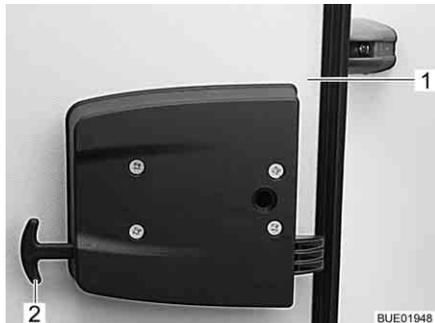
Bild 50 Notentriegelung Garagenklappe
