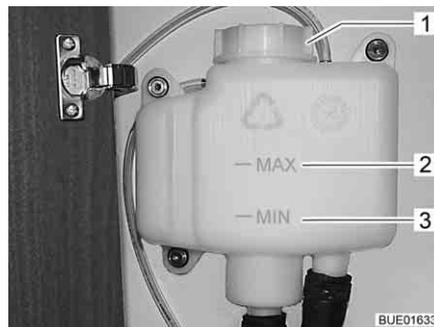
Bild 264 Ausgleichsbehälter ohne Blende
