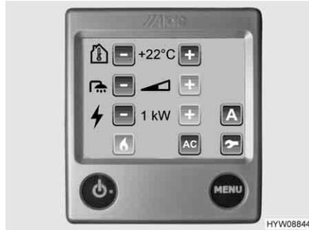
Bild 196 Einstellmenü (Bedieneinheit)
