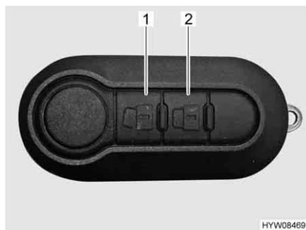
Bild 42 Fernbedienung Zentralverriegelung (2 Tasten)
