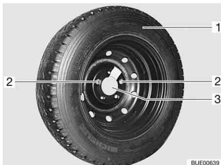
Bild 279 Ersatzrad-Halterung in der Heckgarage
