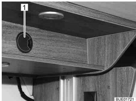
Bild 127 Zugang zum Antrieb
