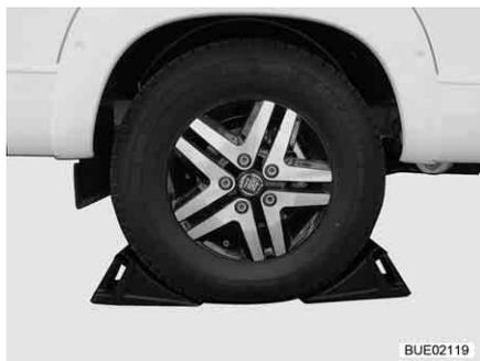
Bild 278 Fahrzeug sichern
