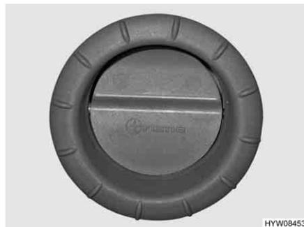
Bild 189 Luftaustrittsdüse (Warmluft-Heizung)
