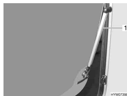
Kuva 69 Avattavat ikkunat, joissa on automaattipidikkeet
