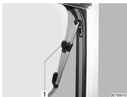
Kuva 68 Avattavat ikkunat, joissa on kääntöpide
