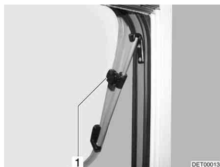
Fig. 109 Fenêtre projetante avec bras pivotant
