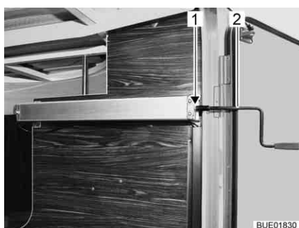
Fig. 147 Manivelle dans le garage arrière
