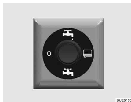
Fig. 241 Commutateur de commande du robinet de vidange à commande électrique (partiellement équipement spécial)
