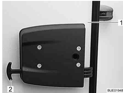
Fig. 72 Dispositif de déverrouillage de secours du portillon de garage
