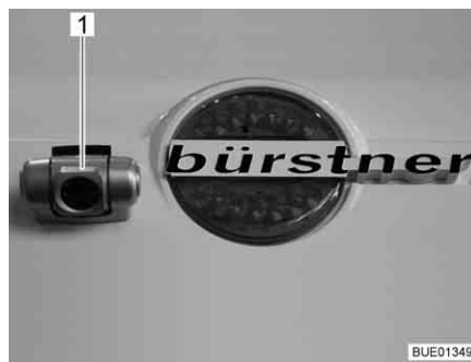
Fig. 22 Caméra de marche arrière avec éclairage à infrarouge
