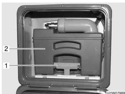
Fig. 256 Depósito de aguas fecales (ejemplo)
