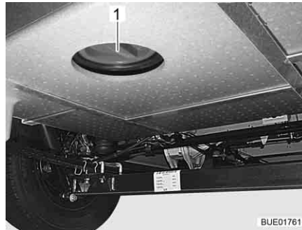
Fig. 257 Orificio de limpieza del depósito de aguas residuales
