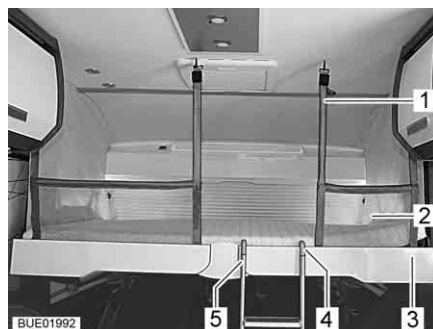
Fig. 142 Cama elevada con red de seguridad tendida
