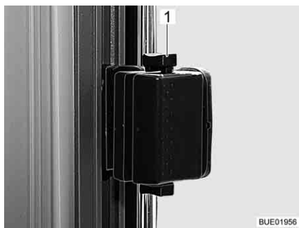
Fig. 113 Ventana corredera bloqueada
