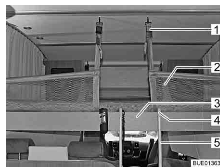
Fig. 144 Cama elevada con red de seguridad tendida
