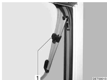
Fig. 109 Ventana abatible con soporte giratorio
