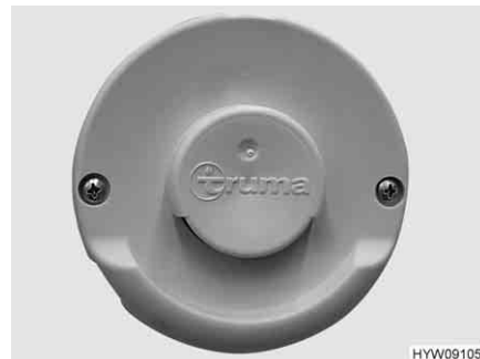
Fig. 200 Tubo de chimenea en la pared de la calefacción de aire caliente
