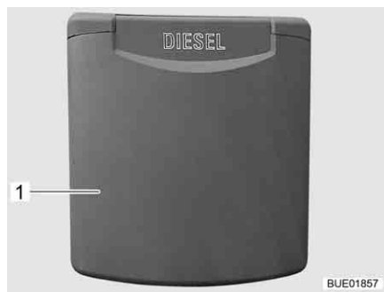
Fig. 48 Trampilla exterior, tubo de llenado de combustible
