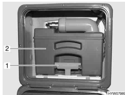
Fig. 247 Depósito de aguas fecales (ejemplo)
