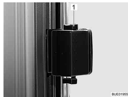
Fig. 114 Ventana corredera, desbloqueada
