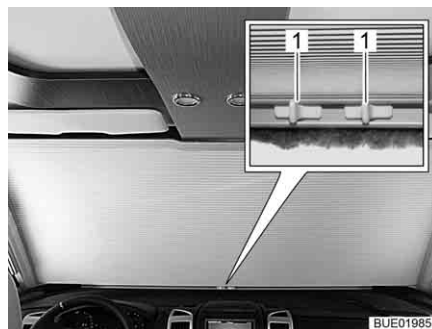
Bild 120 Manuell mörkläggningsgardin, stängd
