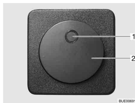
Bild 203 Brytare för elektrisk golvvärme
