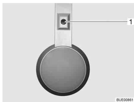
Fig. 61 Lampada, interruttore luci direttamente sulla lampada
