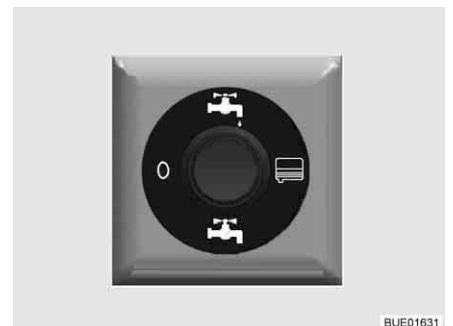
Bild 213 Brytare för elmanövrerad avtappningskran
