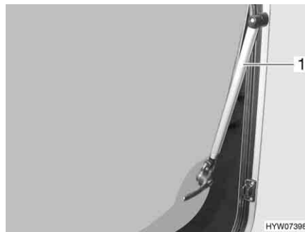
Bild 80 Överkantshängt fönster med automatik-spärr
