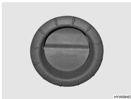
Bild 161 Luftaustrittsdüse der Warmluftheizung
