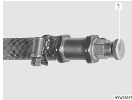
Fig. 235 Válvula de purga de la calefacción de agua caliente
