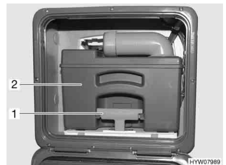
Fig. 229 Depósito de aguas fecales
