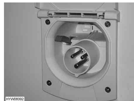
Fig. 101 Collegamento a 230 V sul veicolo
