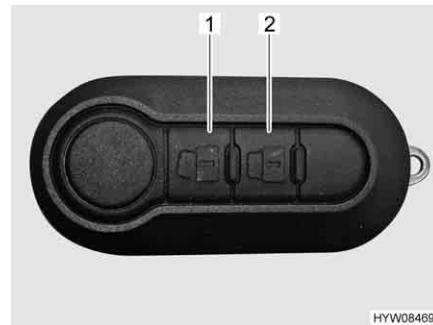
Fig. 25 Telecomando chiusura centralizzata
