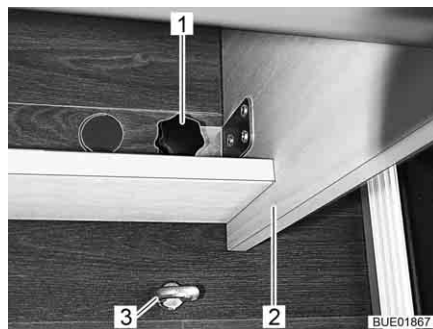
Fig. 85 Fissaggio del sideboard e occhiello di ancoraggio
