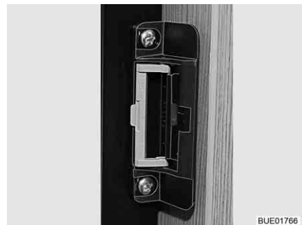
Fig. 139 Dispositivo di chiusura in posizione di ricircolo d'aria
