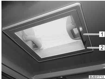
Bild 77 Dachhaube mit Schnappver- schluss
