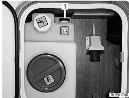
Bild 210 Wassertank (zentrale Versorgungseinheit)
