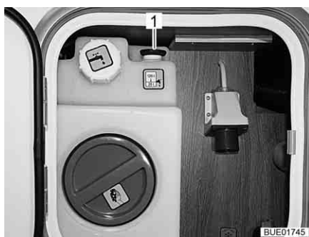
Bild 209 Wassertank (zentrale Versorgungseinheit)
