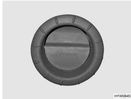
Bild 163 Luftaustrittsdüse der Warmluftheizung
