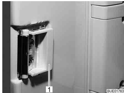
Bild 202 Verschlusseinrichtung in Normalstellung
