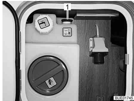
Fig. 209 Depósito de agua (unidad de alimentación centralizada)
