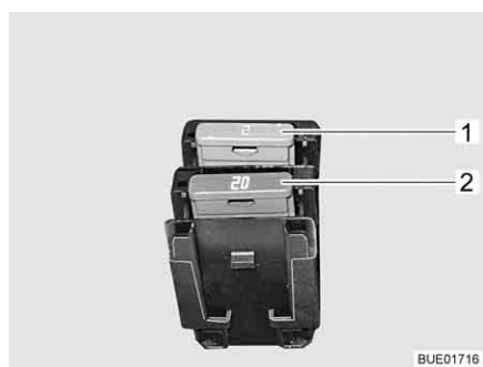
Fig. 151 Fusibles para cama elevada
