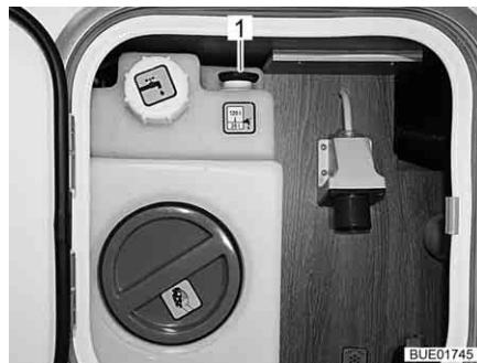
Fig. 210 Depósito de agua (unidad de alimentación centralizada)
