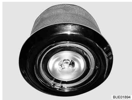
Fig. 55 Lámpara de techo, separada del interruptor (ejemplo)
