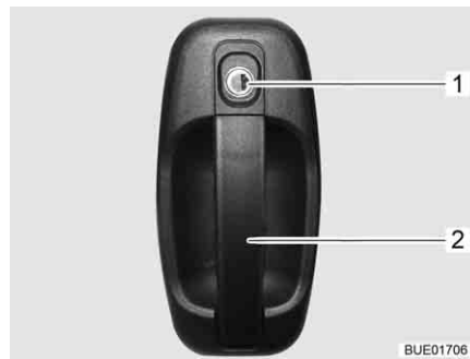
Fig. 40 Cerradura de la puerta de entrada, en el exterior
