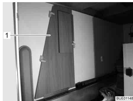
Fig. 16 Rallonge latérale de lit dans le garage arrière
