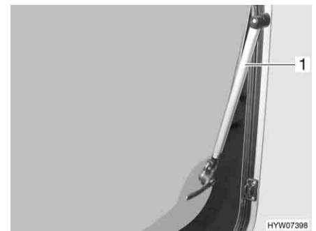
Fig. 68 Fenêtre projetante avec bras automatique
