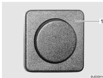
Fig. 56 Interrupteur, séparé de la lampe (exemple)
