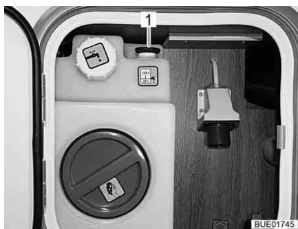
Fig. 209 Réservoir d'eau (unité d'alimentation centrale)
