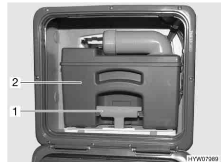
Billede 219 Toilettank (eksempel)
