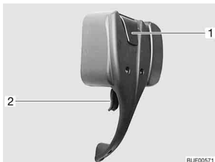
Kuva 42 Sisäänkäyntioven lukko, sisällä, lukittu
