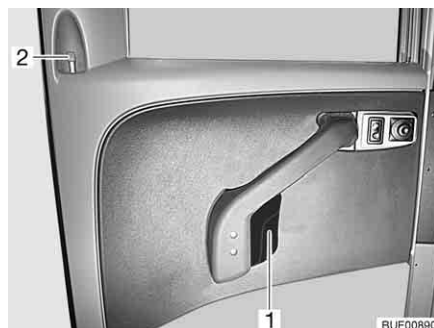
Bild 54 Dörrlås förardörr, insida
