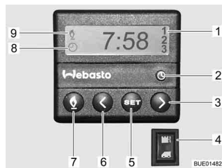
Bild 204 Kontrollenhet för motorvärme
