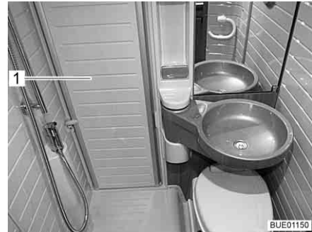
Kuva 16 Suihkuseinä
