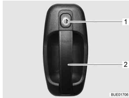
Kuva 55 Sisäänkäyntioven lukko, ulkoa
