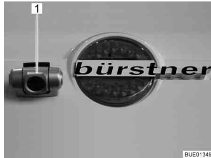
Fig. 17 Cámara de marcha atrás con iluminación infrarroja
