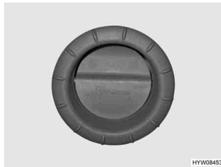
Fig. 187 Boquilla de salida de aire de la calefacción de aire caliente
