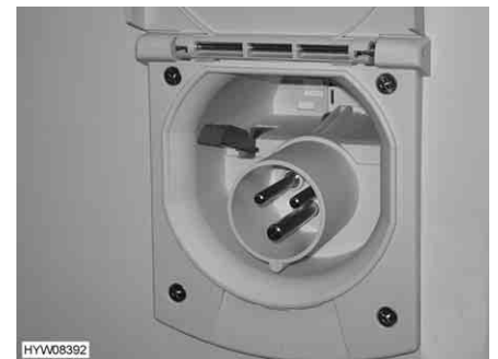
Fig. 164 Conexión de 230 V en el vehículo
