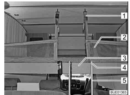
Fig. 131 Cama elevada con red de seguridad tendida
