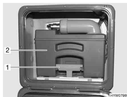
Fig. 264 Depósito de aguas fecales
