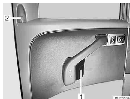
Fig. 54 Cerradura de la puerta del conductor, en el interior
