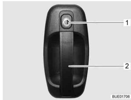
Fig. 55 Cerradura de la puerta de entrada, en el exterior
