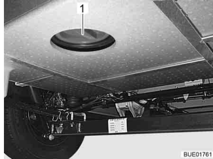
Fig. 265 Orificio de limpieza del depósito de aguas residuales
