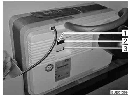
Fig. 159 Campo de conexiones de la pila de combustión
