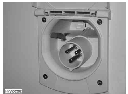
Fig. 164 Raccordement 230 V sur le véhicule
