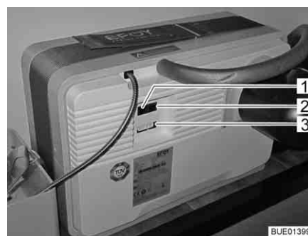
Fig. 159 Champ de raccordement de la pile à combustible
