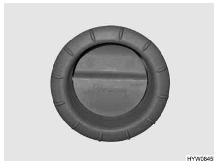
Fig. 187 Buse de sortie d'air du chauffage à air chaud
