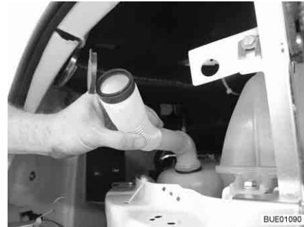
Fig. 42 Bec de remplissage en position de remplissage
