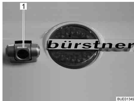
Fig. 17 Caméra de marche arrière avec éclairage à infrarouge
