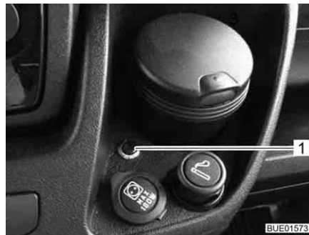
Fig. 47 Bouton-poussoir servant à activer la télécommande
