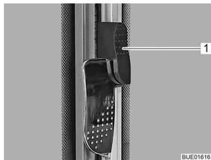
Fig. 103 Fenêtre coulissante avec verrouillage pivotant (verrouillé)
