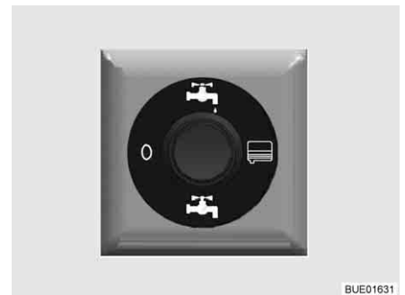
Fig. 247 Commutateur de commande du robinet de vidange à commande électrique (équipement spécial)
