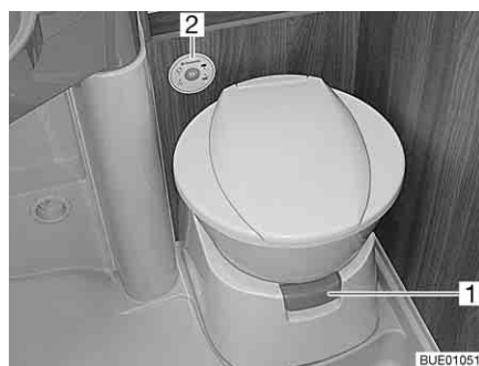
Fig. 261 Cuvette des toilettes avec unité de contrôle et de commande
