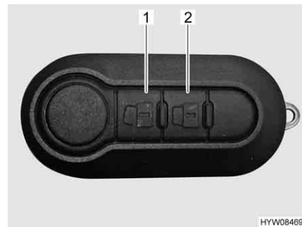
Fig. 52 Télécommande du verrouillage centralisé
