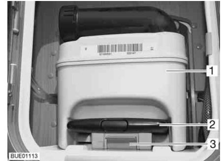
Fig. 252 Réservoir pour matières fécales
