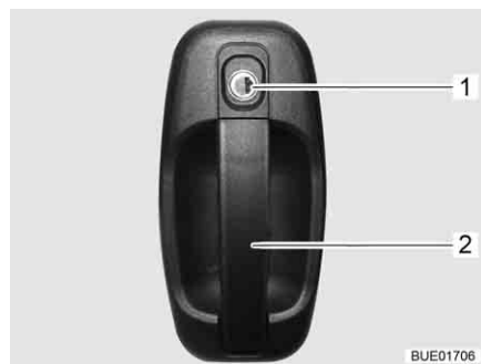
Fig. 55 Serrure de la porte cellule, à l'extérieur
