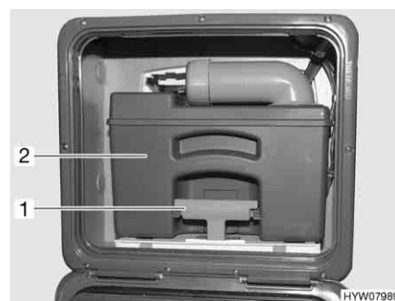
Fig. 264 Réservoir pour matières fécales
