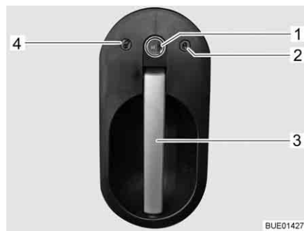
Fig. 53 Serrure de la porte chauffeur, à l'extérieur
