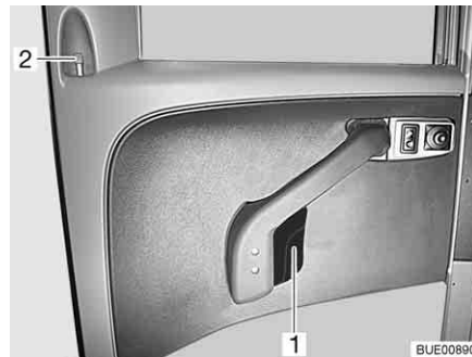
Fig. 54 Serrure de la porte chauffeur, à l'intérieur
