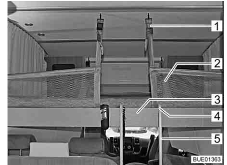
Fig. 131 Lit escamotable avec filet de sécurité tendu
