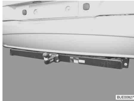
Fig. 9 Dispositif d'attelage, rigide
