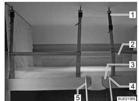
Billede 114 Hejseseng med opspændt sikkerhedsnet
