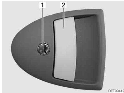
Billede 39 Indgangsdørens dørlås, udvendigt
