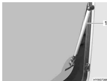
Billede 75 Ventilationsrude med automatiske udskydere
