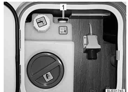
Bild 234 Vattentank (central försörjningsenhet)
