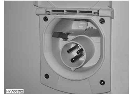
Afb. 109 230-V-aansluiting op het voertuig
