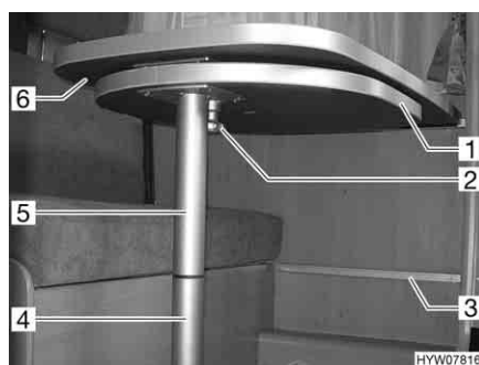
Afb. 78 Hangtafel met inklapbare steunpoot
