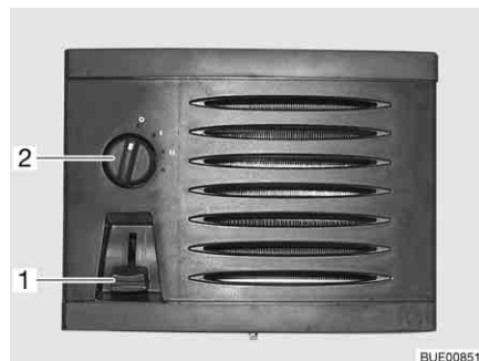
Fig. 192 Boutons de commande d'échangeur de chaleur supplémentaire
