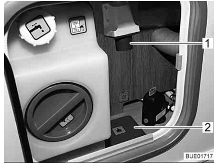
Fig. 157 Raccordement 230 V sur le véhicule (avec unité d'alimentation centrale)
