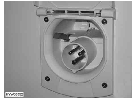
Fig. 158 Raccordement 230 V sur le véhicule (avec unité d'alimentation centrale)
