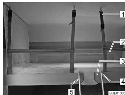
Fig. 114 Lit escamotable avec filet de sécurité tendu
