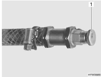
Fig. 260 Soupape de purge pour le chauffage à eau chaude
