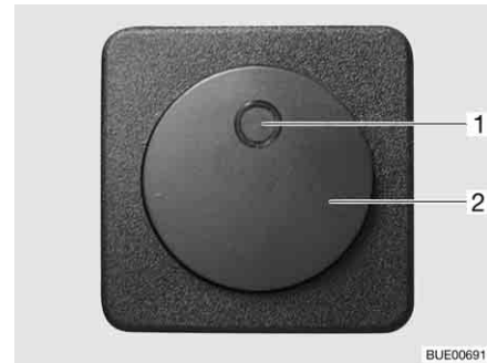
Fig. 194 Commutateur du chauffage électrique du plancher
