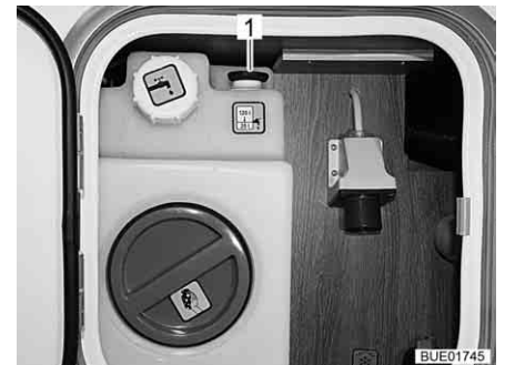
Fig. 232 Réservoir d'eau (unité d'alimentation centrale)
