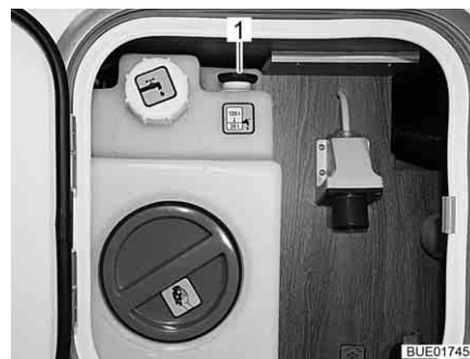
Fig. 234 Réservoir d'eau (unité d'alimentation centrale)
