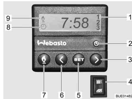
Fig. 195 Unité de commande pour le chauffage d'appoint
