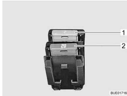
Fig. 168 Fusibles pour le lit escamotable
