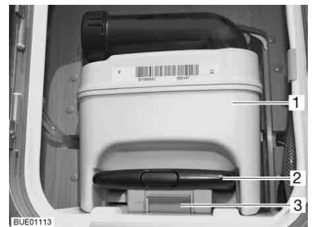
Fig. 243 Réservoir pour matières fécales
