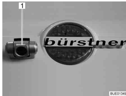
Fig. 11 Cámara de marcha atrás con iluminación infrarroja
