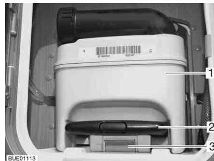
Fig. 165 Depósito de aguas fecales
