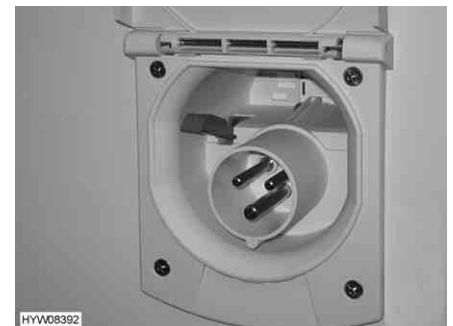
Fig. 109 Conexión de 230 V en el vehículo
