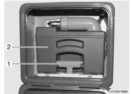
Fig. 177 Depósito de aguas fecales
