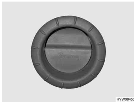
Bild 126 Luftaustrittsdüse der Warmluftheizung
