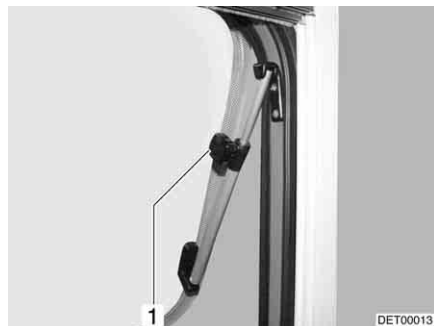
Afb. 99 Dakluik met draaibare uitzetters, geopend
