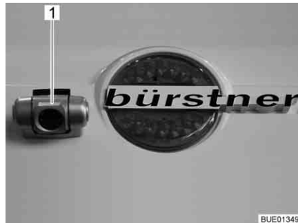
Afb. 20 Achteruitrijcamera met infraroodverlichting (Waeco)
