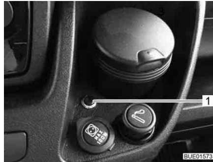
Afb. 37 Drukknop voor het activeren van de afstandsbediening
