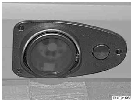
Afb. 236 LED-lamp met schakelaar
