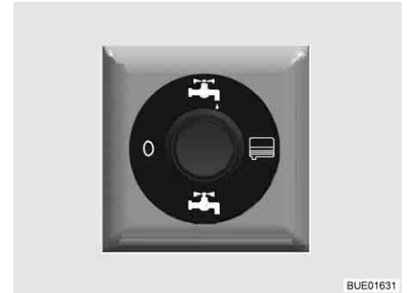
Afb. 205 Bedieningsschakelaar voor elektrisch bediende aftapkraan
