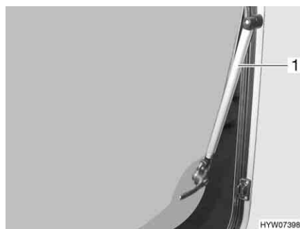
Afb. 81 Uitzetbaar raam met automatische uitzetters
