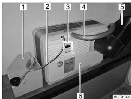
Fig. 137 Gerador 12 V com cartucho de combustível
