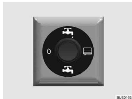
Fig. 205 Interruptor de comando para a válvula de descarga de acionamento elétrico
