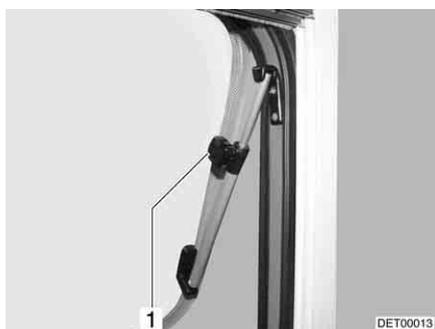
Fig. 76 Janela de projetar com defletor rotativo
