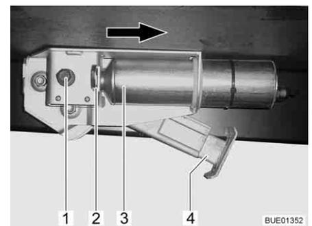
Fig. 38 Apoio de elevação elétrico no veículo
