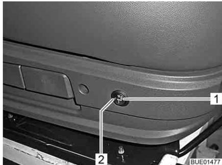
Fig. 27 Interruptor para o aquecimento dos bancos
