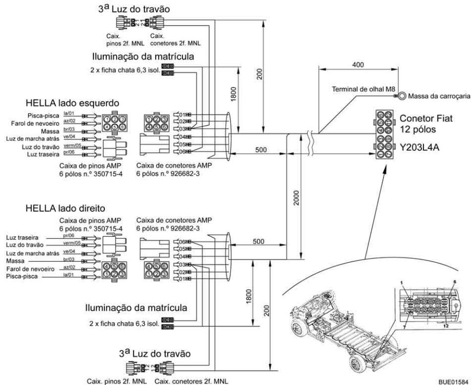
Fig. 161 Esquema elétrico exterior
