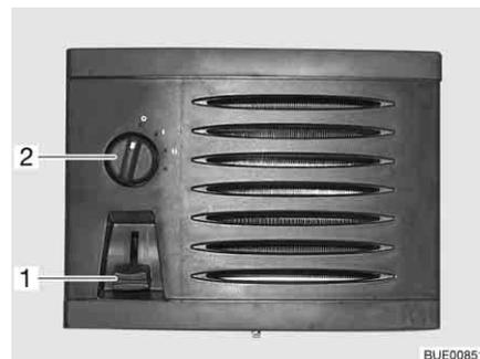
Fig. 173 Elementos de comando do permutador de calor suplementar
