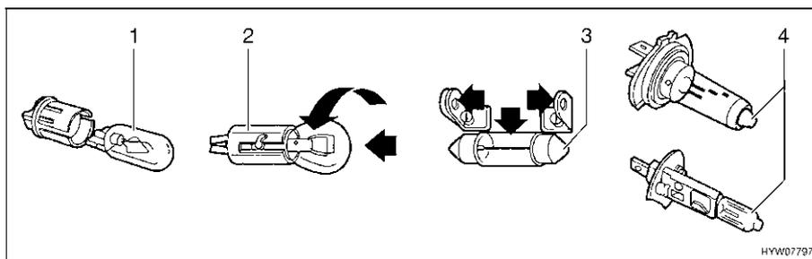
Fig. 230 Tipos de lâmpadas incandescentes
