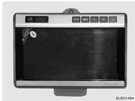
Fig. 22 Ecrã LCD para câmara de recuo (Waeco)
