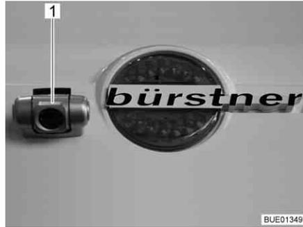
Fig. 20 Câmara de recuo com iluminação de infravermelhos (Waeco)
