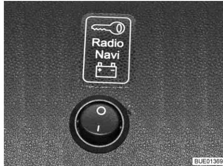
Fig. 132 Interruptor-seletor para o comportamento da bateria
