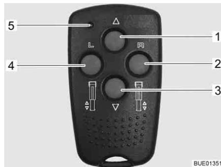
Fig. 36 Controlo remoto para apoios de elevação elétricos
