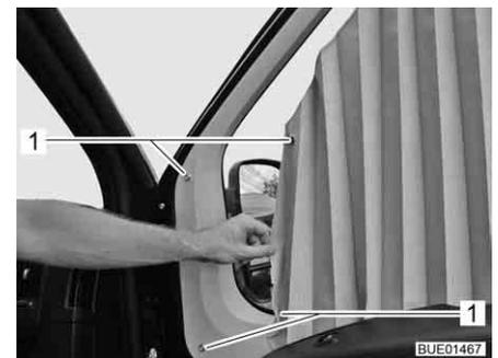
Fig. 87 Fixação da cortina plissada
