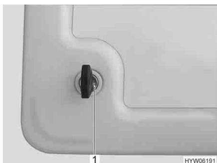
Fig. 51 Fechadura de pressão do alçapão de serviço
