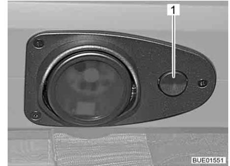
Fig. 64 Lâmpada encastrada com LED
