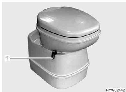
Fig. 218 Bacia da sanita Thetford, basculante
