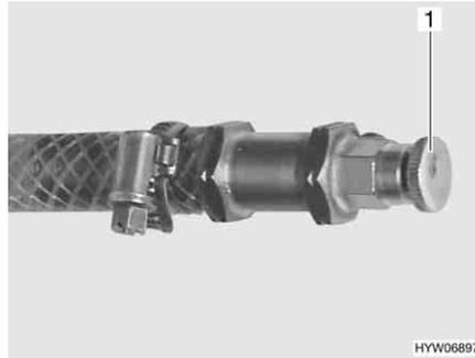
Fig. 229 Válvula de evacuação de ar para o aquecimento de água
