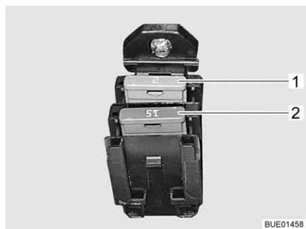
Fig. 150 Fusíveis para o gerador 12 V
