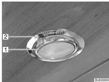
Fig. 237 Lâmpada de halogéneo encastrada (achatada)
