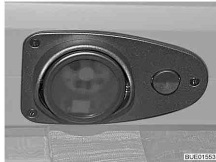
Fig. 236 Lâmpada com LED com interruptor
