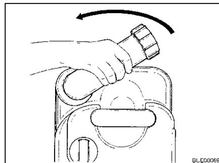
Fig. 216 Girar o bocal de descarga
