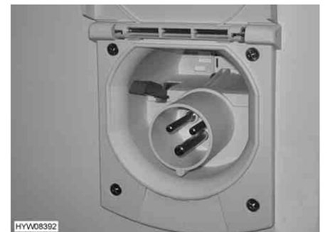
Fig. 143 Ligação de 230 V no veículo
