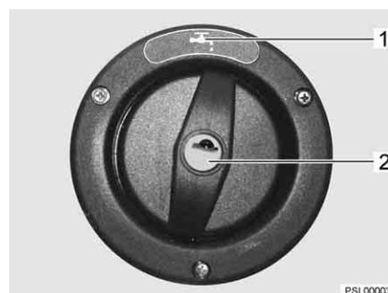
Fig. 53 Tampa de fecho do bocal de enchimento de água potável
