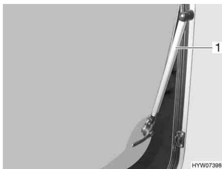
Fig. 81 Janela de projetar com defletor automático
