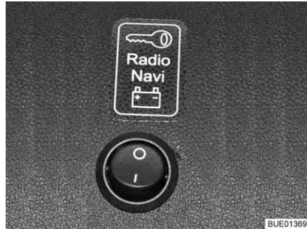
Bild 132 Wahlschalter für Betriebsverhalten
