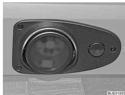
Bild 236 LED-Leuchte mit Schalter
