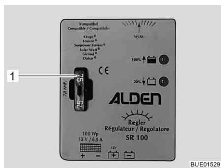
Bild 151 Sicherung Solar-Laderegler 100 W
