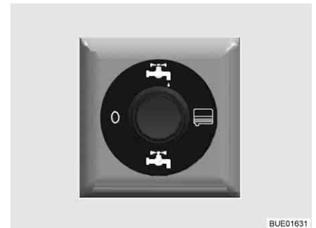
Bild 205 Bedienschalter für elektrisch betätigtes Ablassventil
