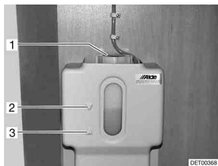
Afb. 254 Buffertank met afscherming
