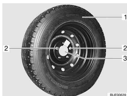
Afb. 280 Reservewielhouder in de garage achter
