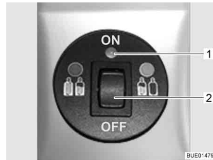
Afb. 145 Bedieningspaneel met afstandsindicatie
