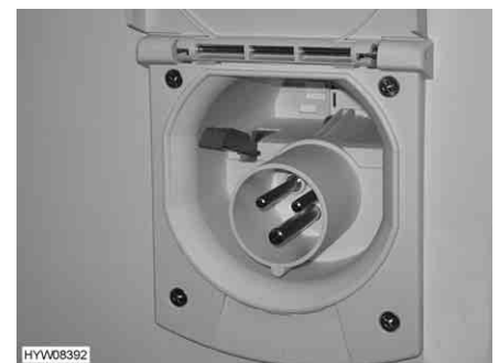
Billede 161 230 V-tilslutning på køretøjet
