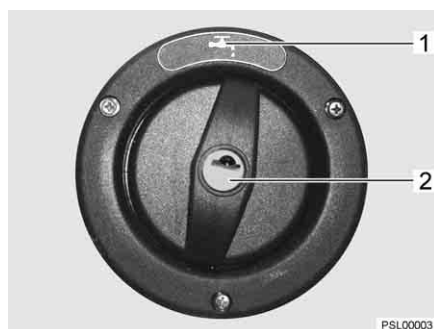
Billede 68 Dæksel til drikkevands-påfyldningsstuds
