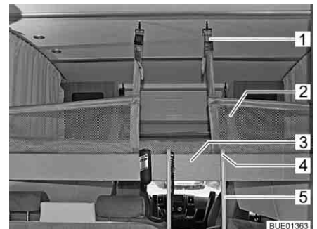
Billede 128 Hejseseng med opspændt sikkerhedsnet
