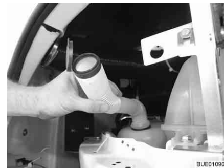
Fig. 45 Bocchettone di riempimento in posizione di riempimento
