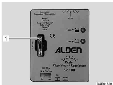
Fig. 170 Fusibile regolatore di carica del pannello solare 100 W
