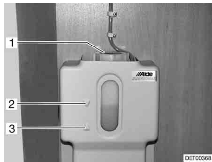
Fig. 254 Vaso d'espansione con diaframma
