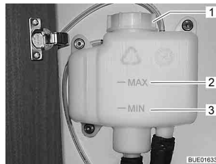
Fig. 255 Vaso d'espansione senza diaframma
