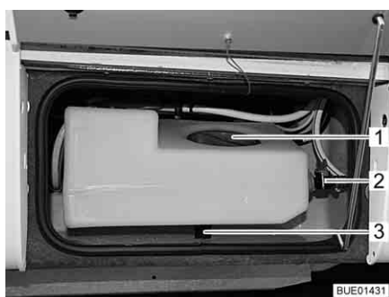
Fig. 223 Serbatoio dell'acqua aggiuntivo
