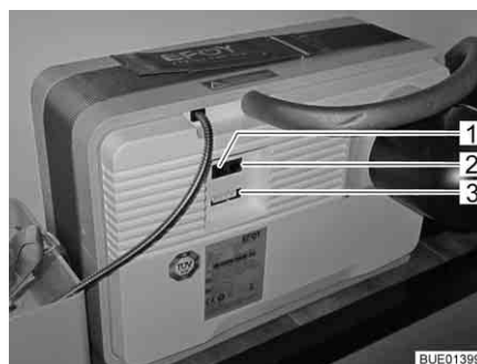
Fig. 156 Campo di collegamento pila a combustibile
