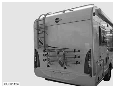
Fig. 2 Portabiciclette per massimo 3 biciclette
