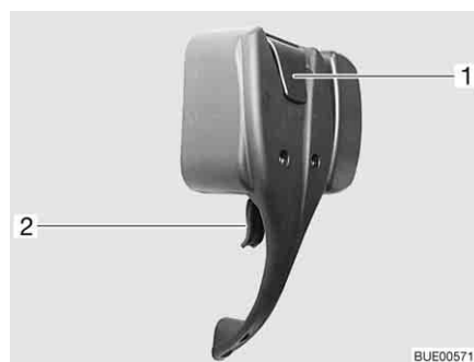
Fig. 30 Serrure de la porte cellule, à l'intérieur, verrouillée
