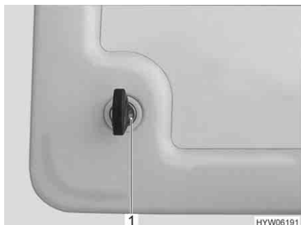
Fig. 38 Verrou de pression portillon de service
